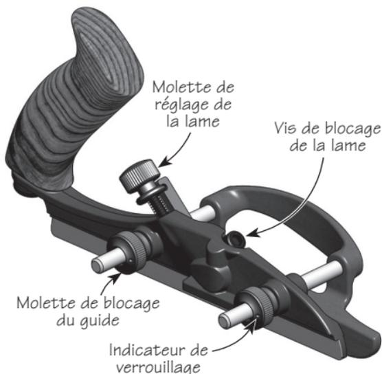
Pour régler le guide, libérer d'abord les deux tiges en desserrant les molettes excentriques de blocage du guide jusqu'à ce que les indicateurs de verrouillage soient orientés vers l'avant de l'outil.
